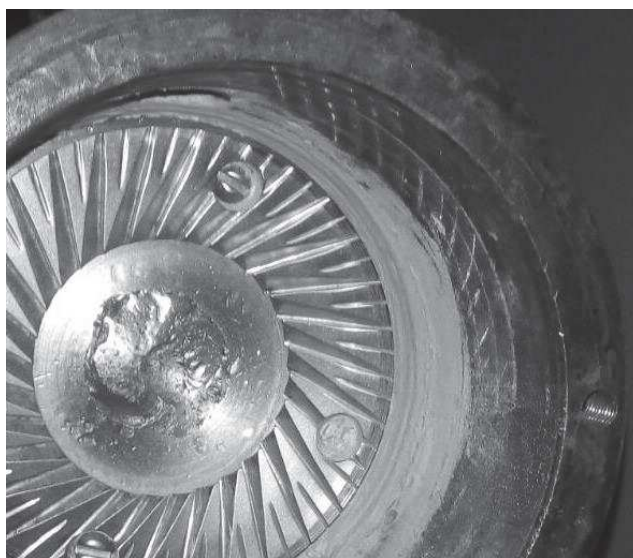
Рисунок 2.9 – Рухомий ніж закріплений на роторі
