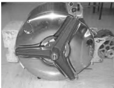
Рисунок 1.3 - Хрестовина в зборі з баком
