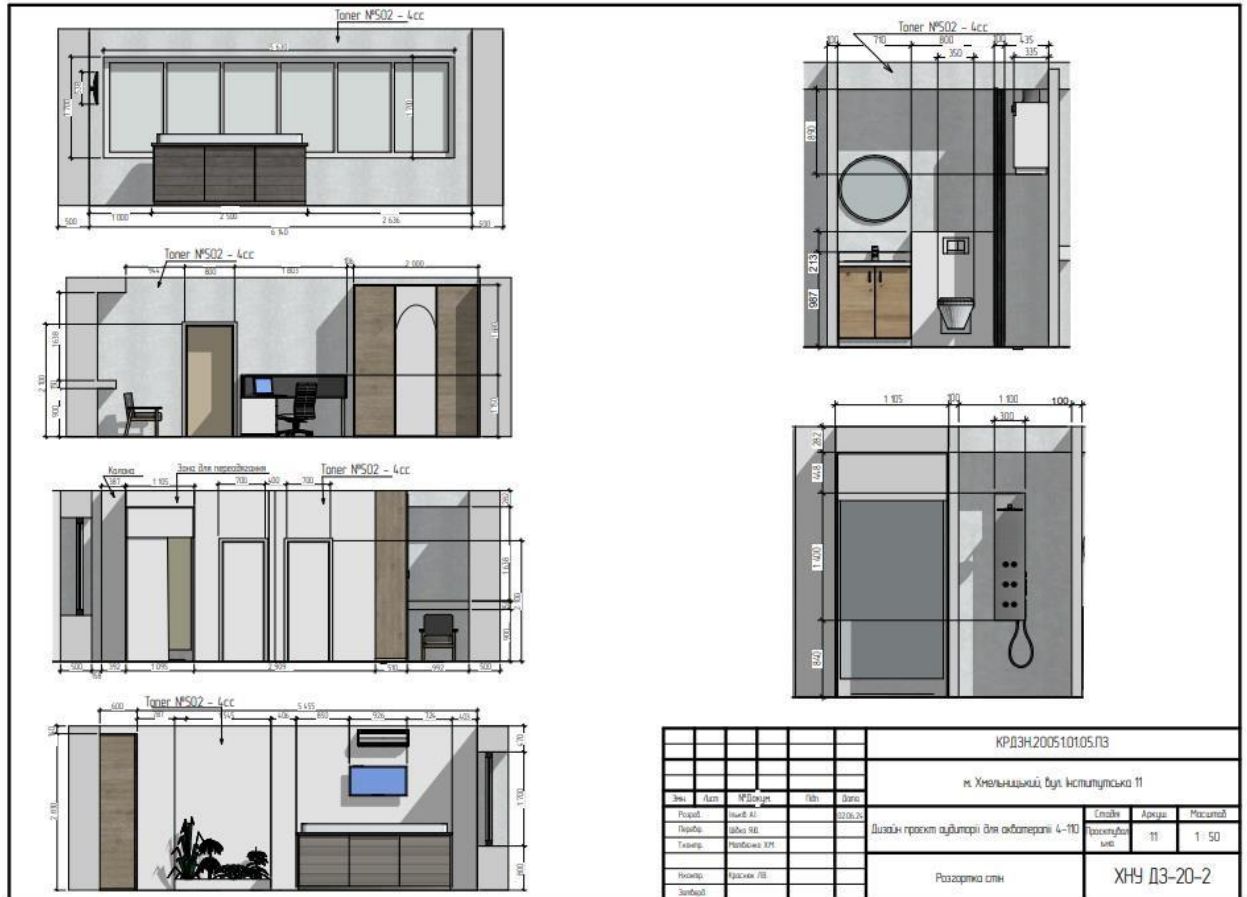
Рисунок 4.13 – Розгортка стін приміщення для акватерапії
