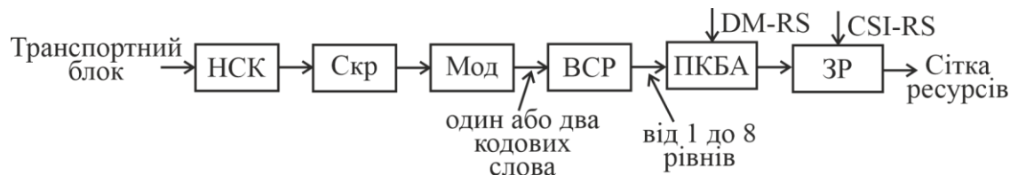
Рисунок 3.6 – Структура загального фізичного каналу низхідної лінії зв'язку (НСК – низхідний спільний канал; Скр – скремблювання; Мод – модуляція; ВСП – відображення кодових слів на певний рівень; ПКБА – попереднє кодування для роботи з багатьма антенами; ЗР – зіставлення елементів ресурсів)
