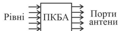
Рисунок 3.7 – Схематичне зображення роботи з багатьма антенами (ПКБА – попереднє кодування для роботи з багатьма антенами)
