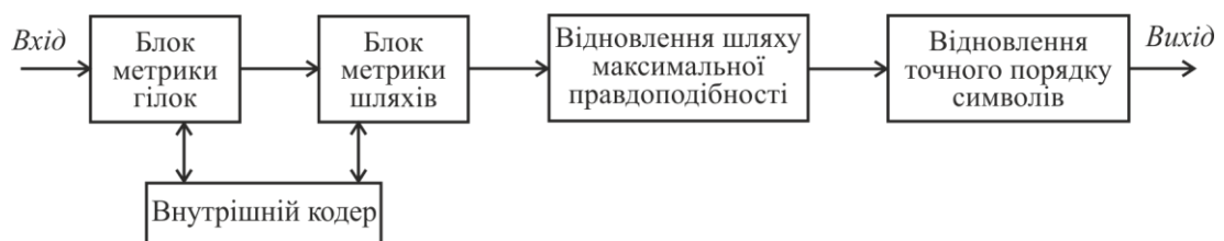
Рисунок 4.9 – Декодер згорткових кодів за алгоритмом Вітербі
