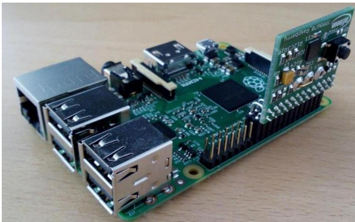
Рисунок 4.1 – Робочий вузол Raspberry Pi Model 3 із підключеним криптографічним модулем Infineon OPTIGA SLB 9670
