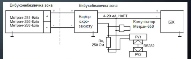
Схема зовнішніх приєднань Метран-286 з бар'єром іскро-захисту: PV1 – HART-модем Метран-681; PV2 – персональний комп'ютер; БЖ- блок живлення; Бар'єр іскро-захисту - 9001/51
