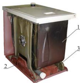
Рис. 1. Пральна машина "Айша" 1 – пральна машина "Айша"; 2 – вантаж масою 6 кг; 3 – вантаж масою 14 кг
