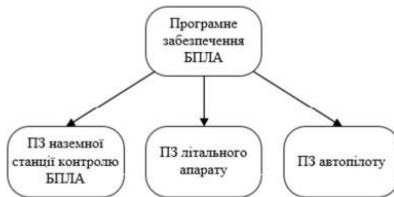
Рисунок 2.1 - Структура програмного забезпечення БПЛА
