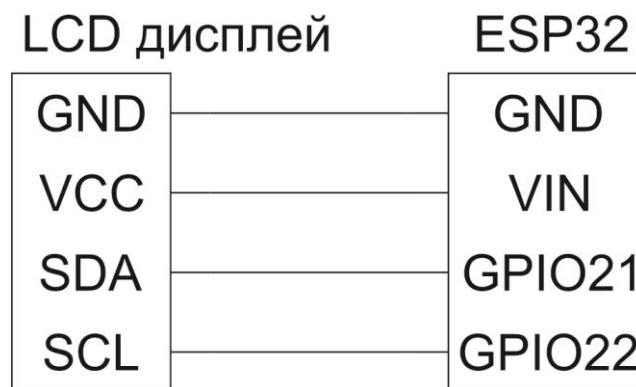
Рисунок 2.20 – З'єднання між LCD дисплеєм та ESP32
