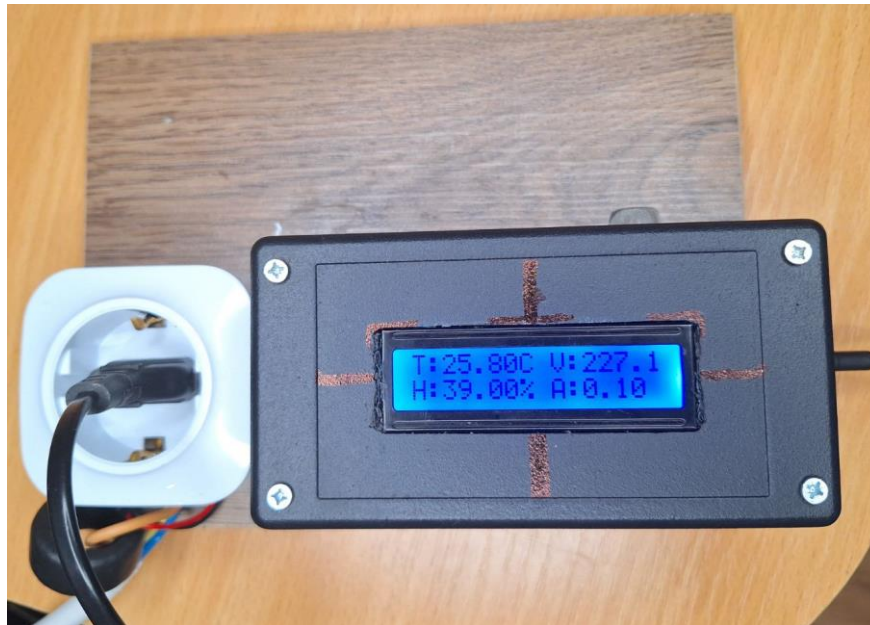
Рисунок 3.8 – Пристрій підключений до живлення та відображенні дані на дисплеї
