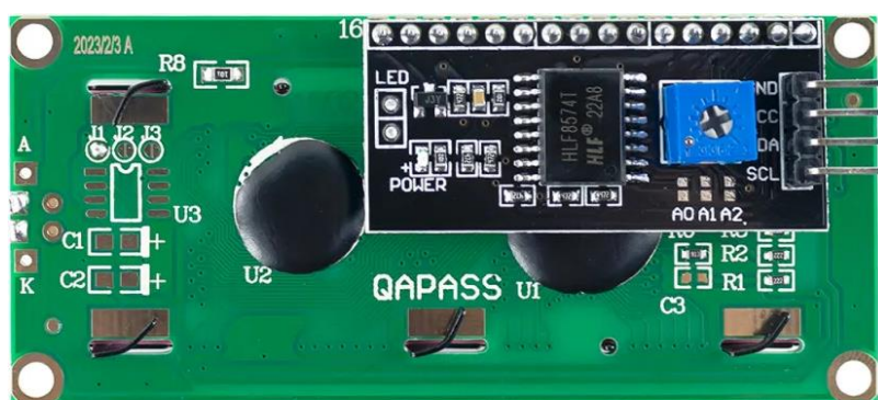
Рисунок 1.26 – Задня частина дисплея, де помітний модуль I2C
