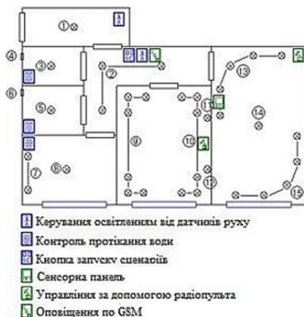
Рисунок 2 – Схема використання датчиків протікання води у підсистемі контролю витоку води і газу в кіберфізичній системі «Розумний будинок» [5]
