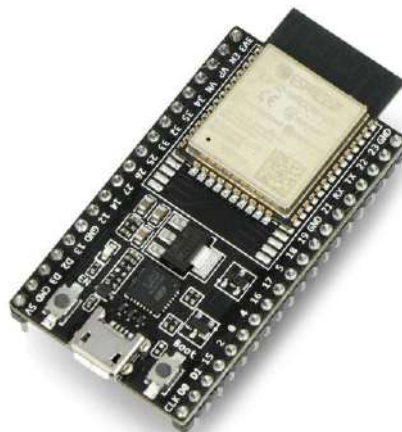
Рисунок 2.2 – Мікроконтролер ESP32 DevKit V4 [43]
