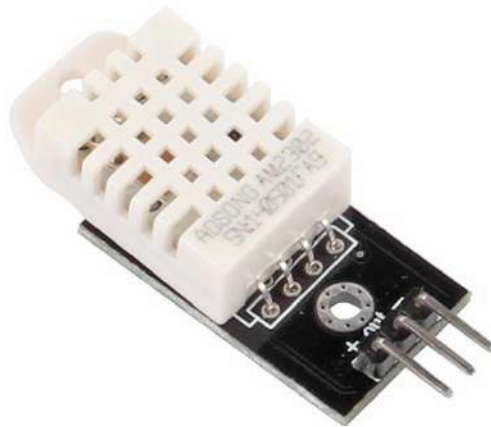
Рисунок 2.6 – Датчик температури та вологості DHT22 [47]
