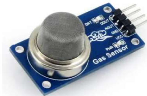
Рисунок 2.3 – Напівпровідниковий датчик MQ-7 [44]
