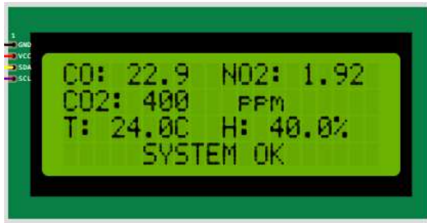
Рисунок 3.3 – Візуалізація даних на локальному дисплеї в нормальному режимі роботи
