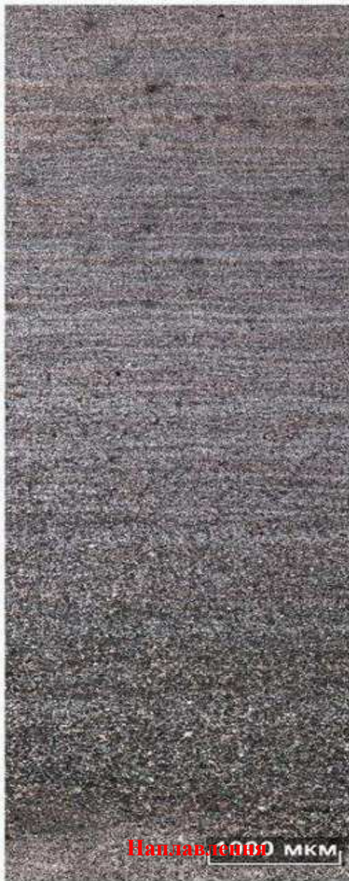
Рисунок 3.16 – Панорами зон термічного впливу зразків, відновлених із застосуванням індукційного підігріву до 250 оС за різних режимів (а – в один прохід, товщиною 9–10 мм, б – у три проходи, товщиною 2,5–3мм кожен)
