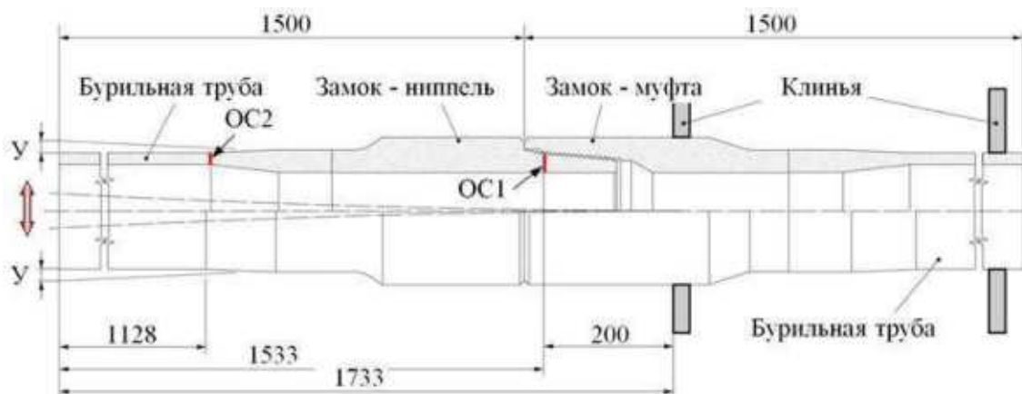
Рисунок 4.5 – Випробувувальний зразок та схема його навантаження
