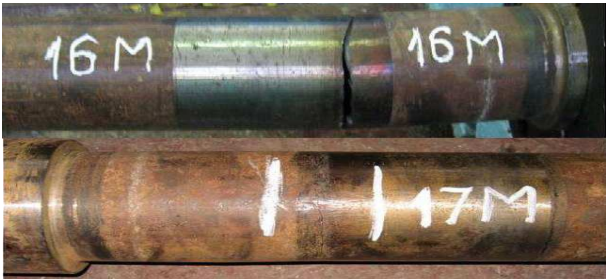
Рисунок 4.13 – Руйнування зразків 16М та 17М бурильної труби ПК 127×9 «Д» за дефектом у тілі труби
