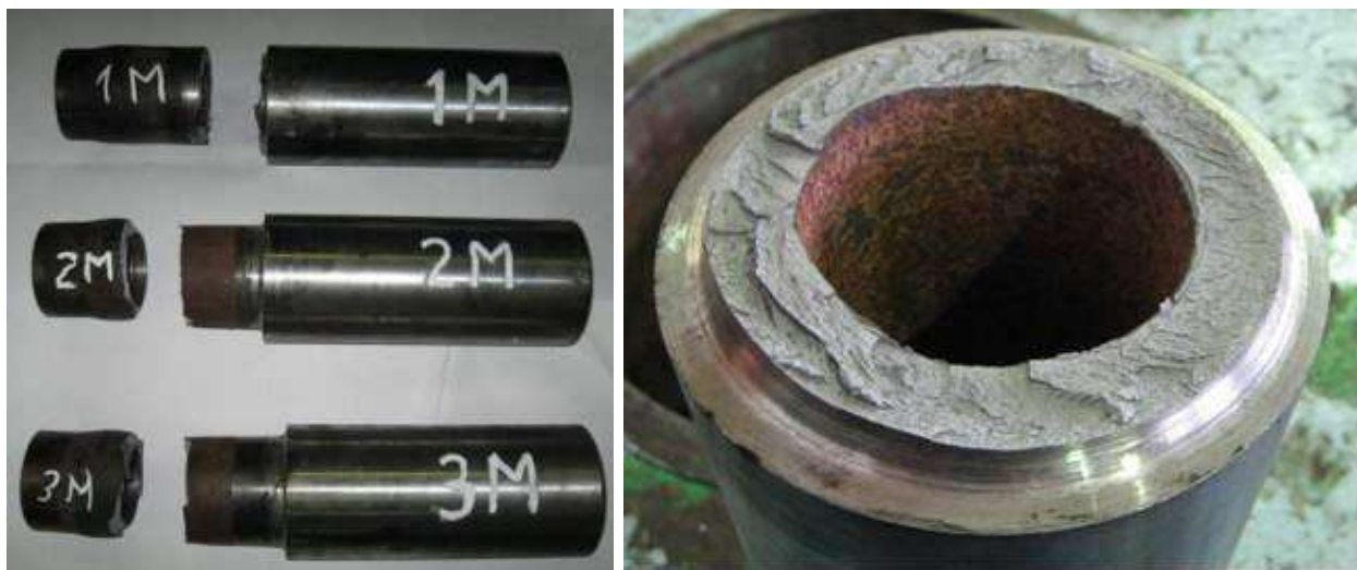
Рисунок 4.3 – Зразки труб ПН 89×9мм після випробувань на розтягування
