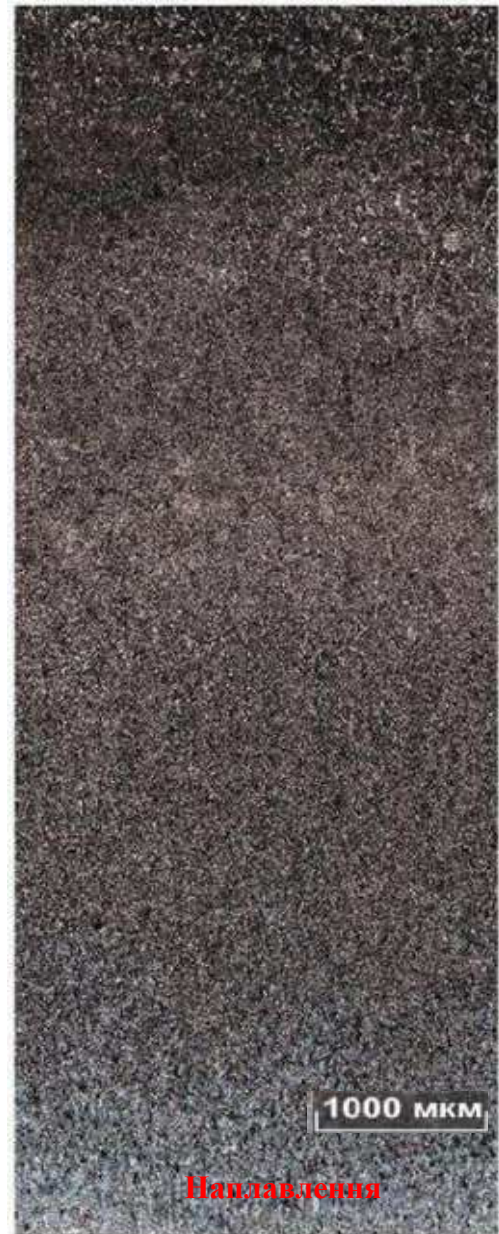
Рисунок 3.16 – Панорами зон термічного впливу зразків, відновлених із застосуванням індукційного підігріву до 250 оС за різних режимів (а – в один прохід, товщиною 9–10 мм, б – у три проходи, товщиною 2,5–3мм кожен)
