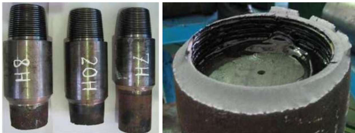
Рисунок 4.2 – Зразки труб ПК 127×9 після випробувань на розтягування
