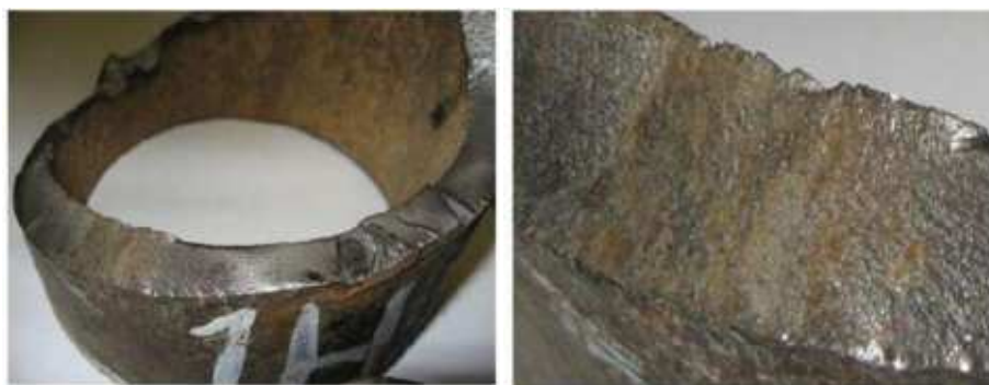
Рисунок 4.11 – Руйнування зразка 1Н бурильної труби ПК 127×9 «Д» із привареним замком ЗП-162-95-2 за дефектом у тілі труби
