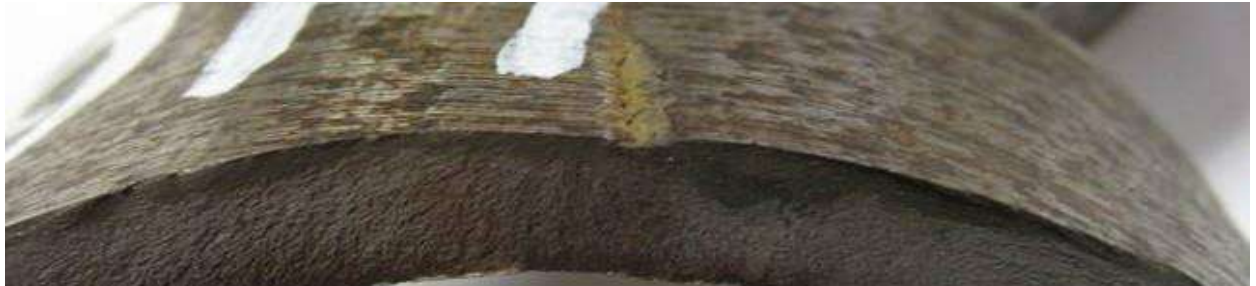
Рисунок 4.12 – Руйнування зразка 9Н бурильної труби ПК 127×9 «Д» із привареним замком ЗП-162-95-2 за дефектом у тілі труби
