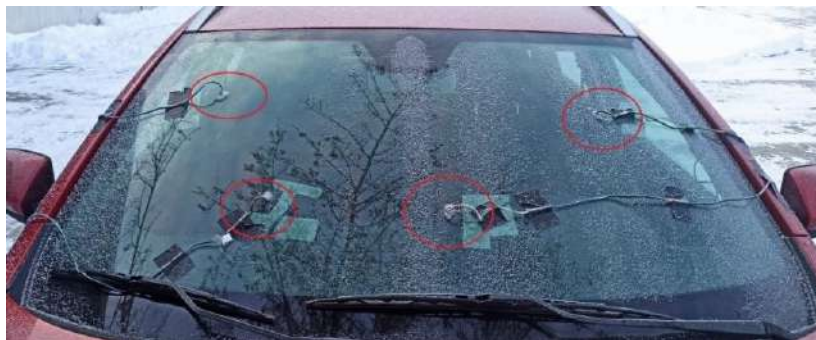
Рисунок 3.1-Встановлення термопар зовні
