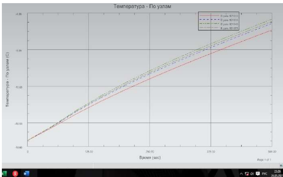
Рисунок- 4.17 Зміна температури у вибраних точках на внутрішній поверхні скла
