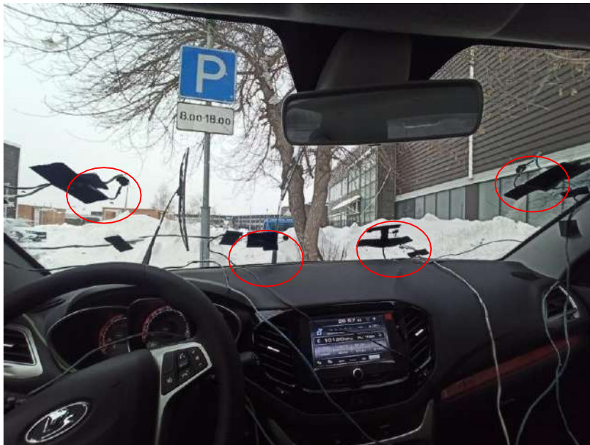
Рисунок 3.2-Встановлення термопар на внутрішню поверхню
