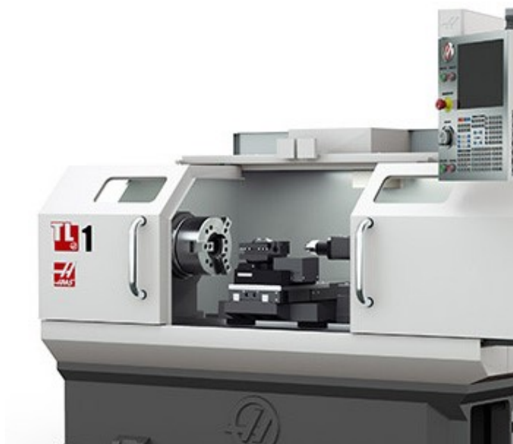
Рисунок 2.3 – Токарний центр моделі HAAS TL-1
