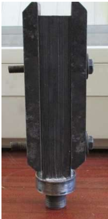
Рисунок 1.14 – Результат індукційної пайки
