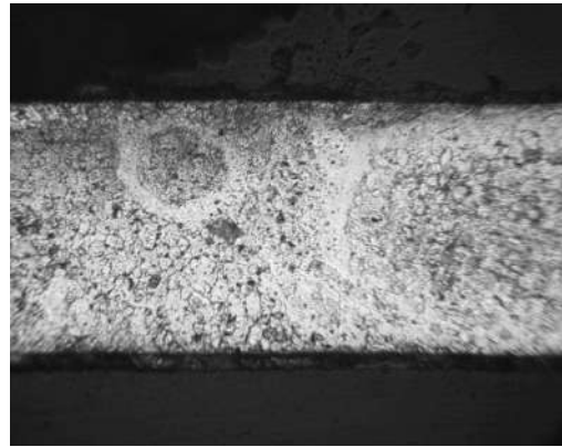
Рисунок 2.23 – Макрошліфи відпалених пластин при 950 °С
