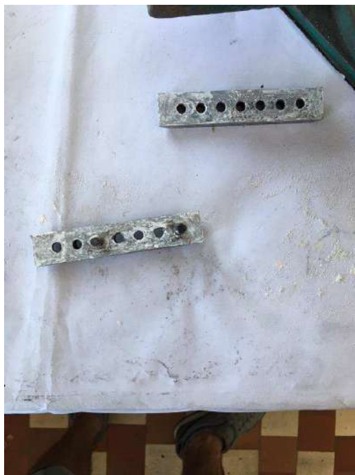
Рисунок 3.16– Пайка з використанням обмазки крейдою струбцин
