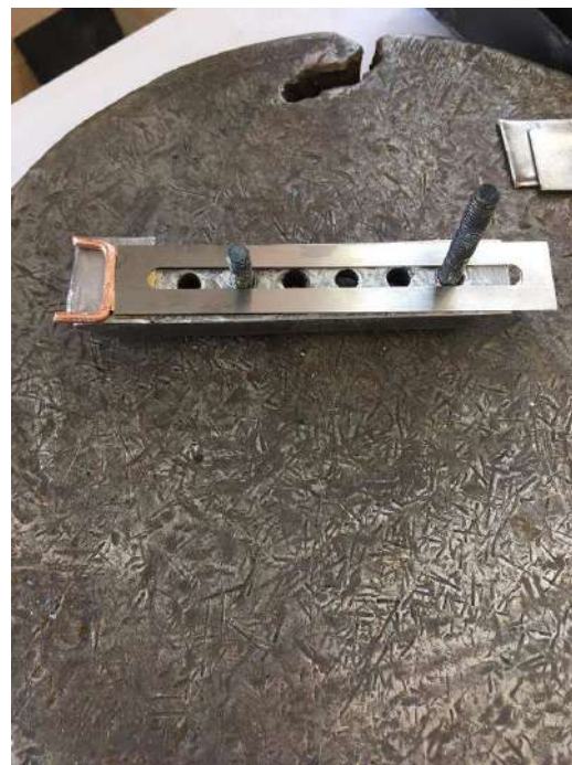
Рисунок 3.16– Пайка з використанням обмазки крейдою струбцин
