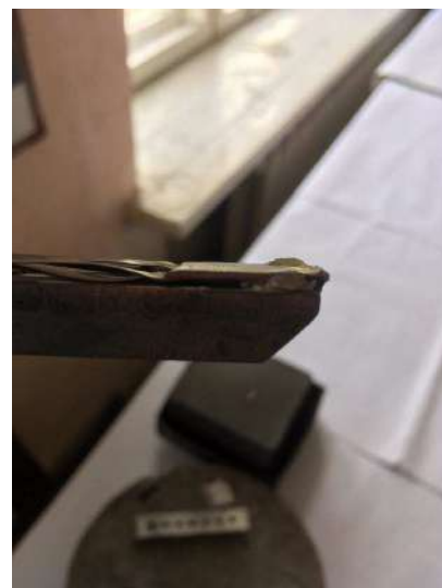
Рисунок 3.17– Результати пайки з використанням обмазки крейдою струбцин
