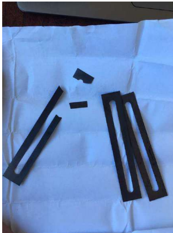
Рисунок 2.19 – Магнітострикційні пластини після відпалу
