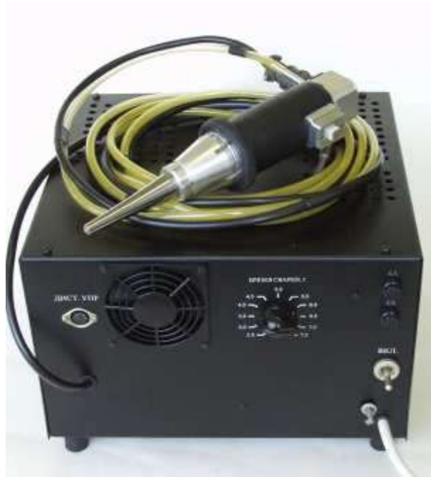
Рисунок 1.4 - Технологічний комплекс ультразвукового зварювання
