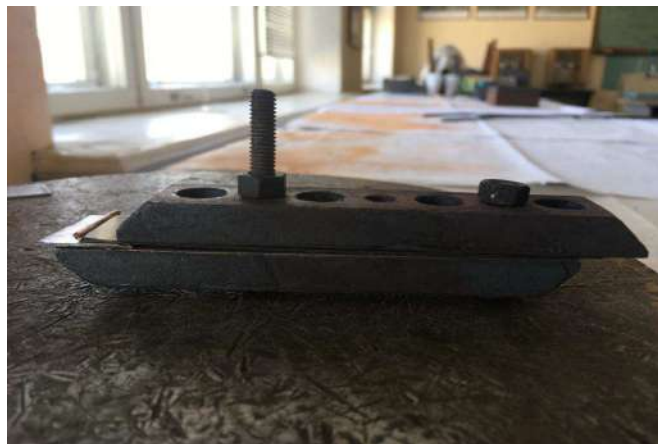
Рисунок 3.7 – Готова до пайки струбцина
