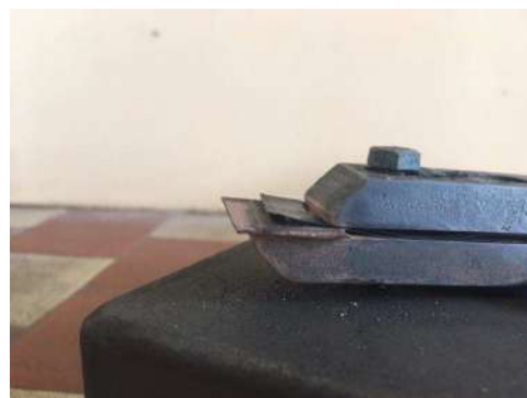
Рисунок 3.14– Результати пайки без сполучення
