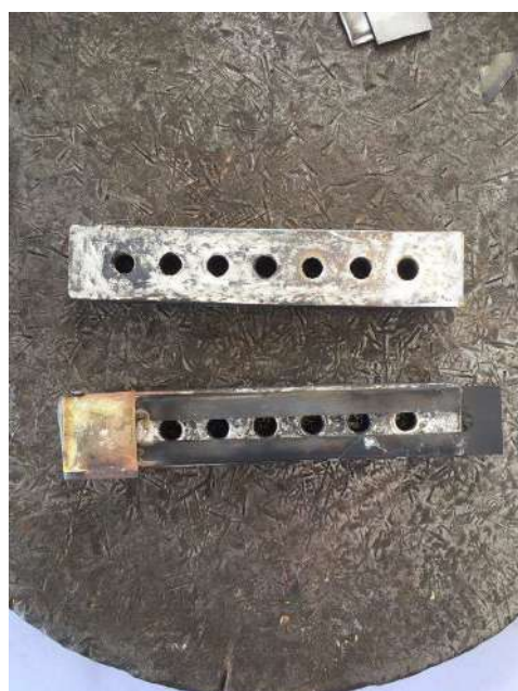
Рисунок 3.17– Результати пайки з використанням обмазки крейдою струбцин
