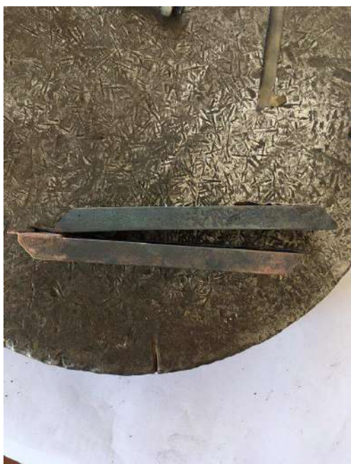
Рисунок 3.15– Результати пайки без сполучення
