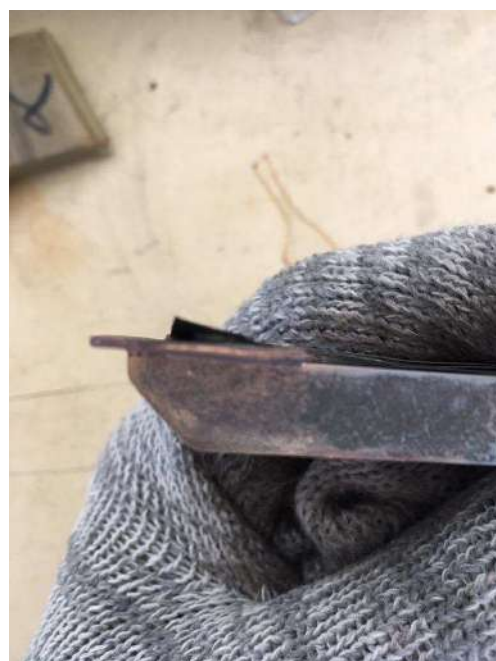
Рисунок 3.15– Результати пайки без сполучення
