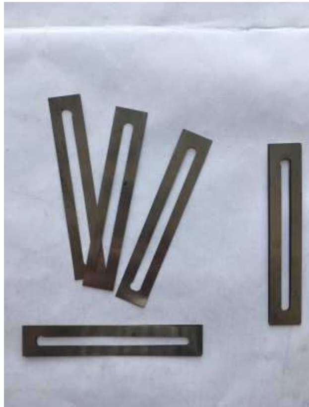
Рисунок 1.9 – Магнітострикційні пластини зі сплаву 49К2ФА
