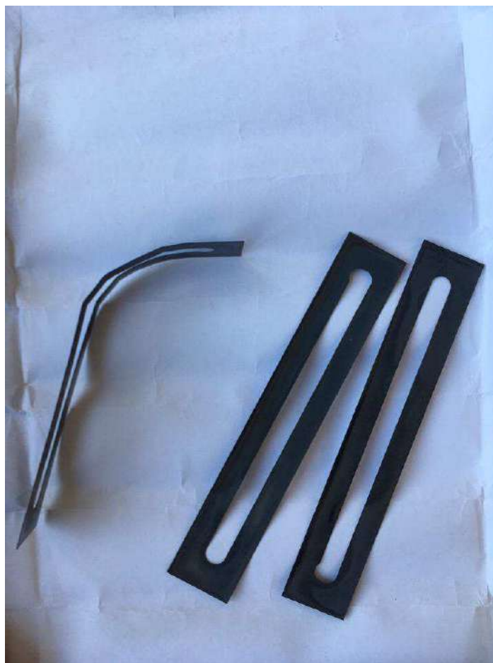
Рисунок 2.28 – Магнітострикційні пластини після скоректованого режиму термообробки
