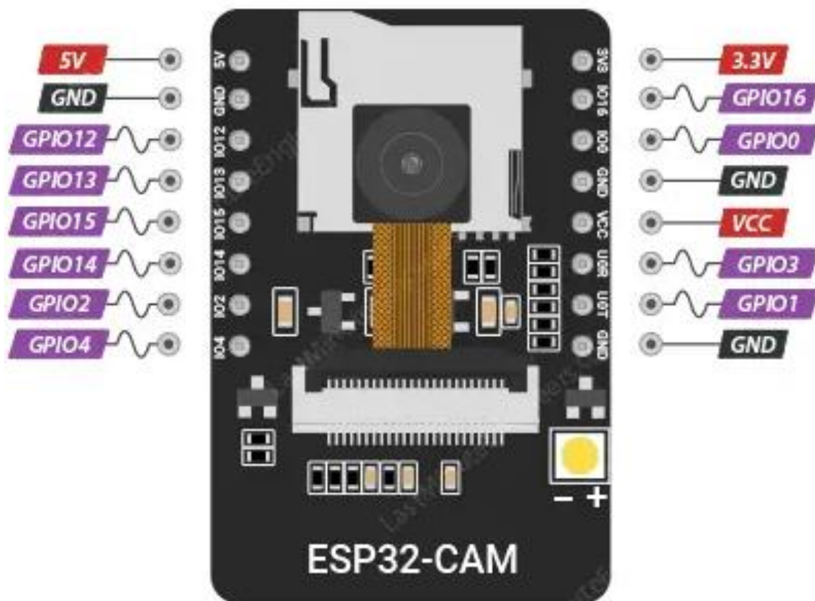
Рисунок 2.3 – Розташування контактів плати ESP32CAM
