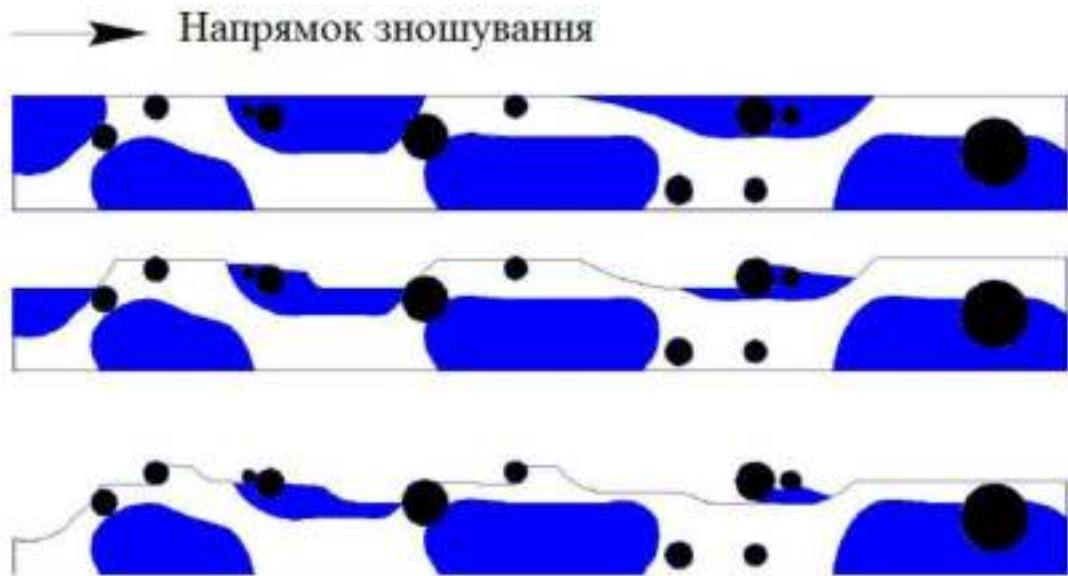
Рисунок 3.14 – Характер руйнування покриття системи Fe-Cr-V-Mo-C пило повітряною абразивною сумішшю
