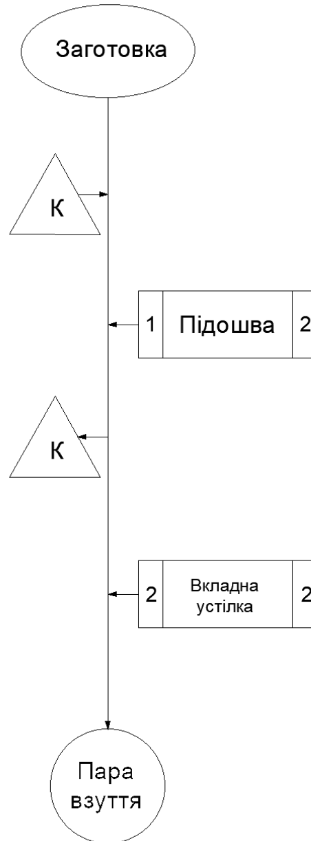
Рисунок 3.2 – Схема складання взуття
