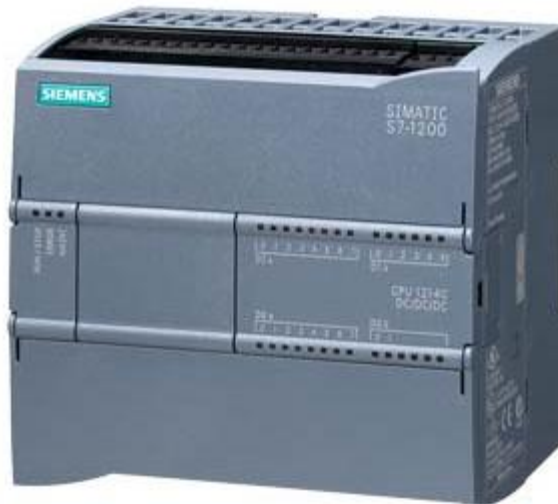
Рисунок 2.6 - Програмований логічний контролер SIMATIC S7-1200 CPU 1214C компанії Siemens [13]
