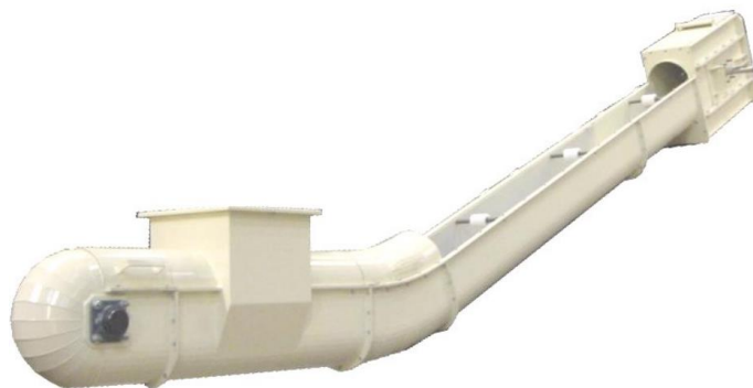
Рисунок 1.3 - Льотовий конвеєрний пристрій [6]
