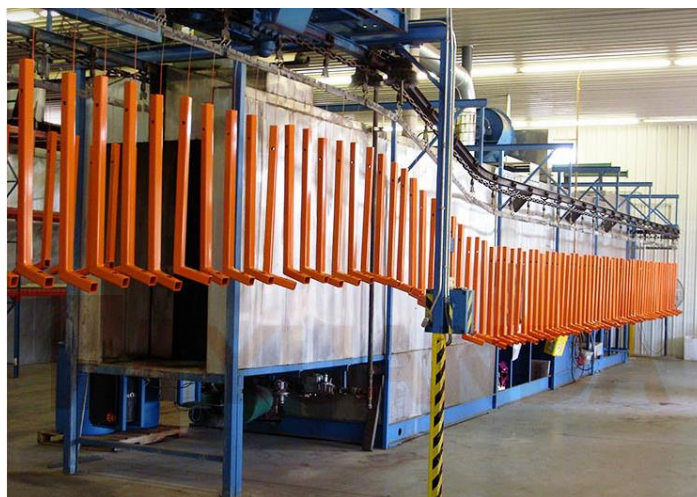
Рисунок 1.4 - Підвісний конвеєрний пристрій [7]
