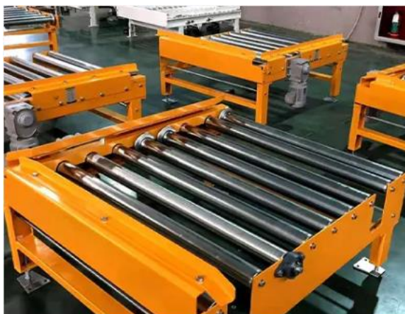
Рисунок 1.5 - Роликовий конвеєрний пристрій [8]
