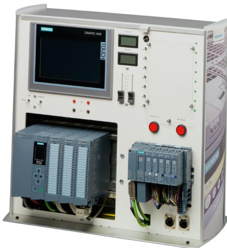
Рисунок 1.1 – Лабораторний стенд для вивчення програмованих логічних контролерів SIMATIC S7-1500
