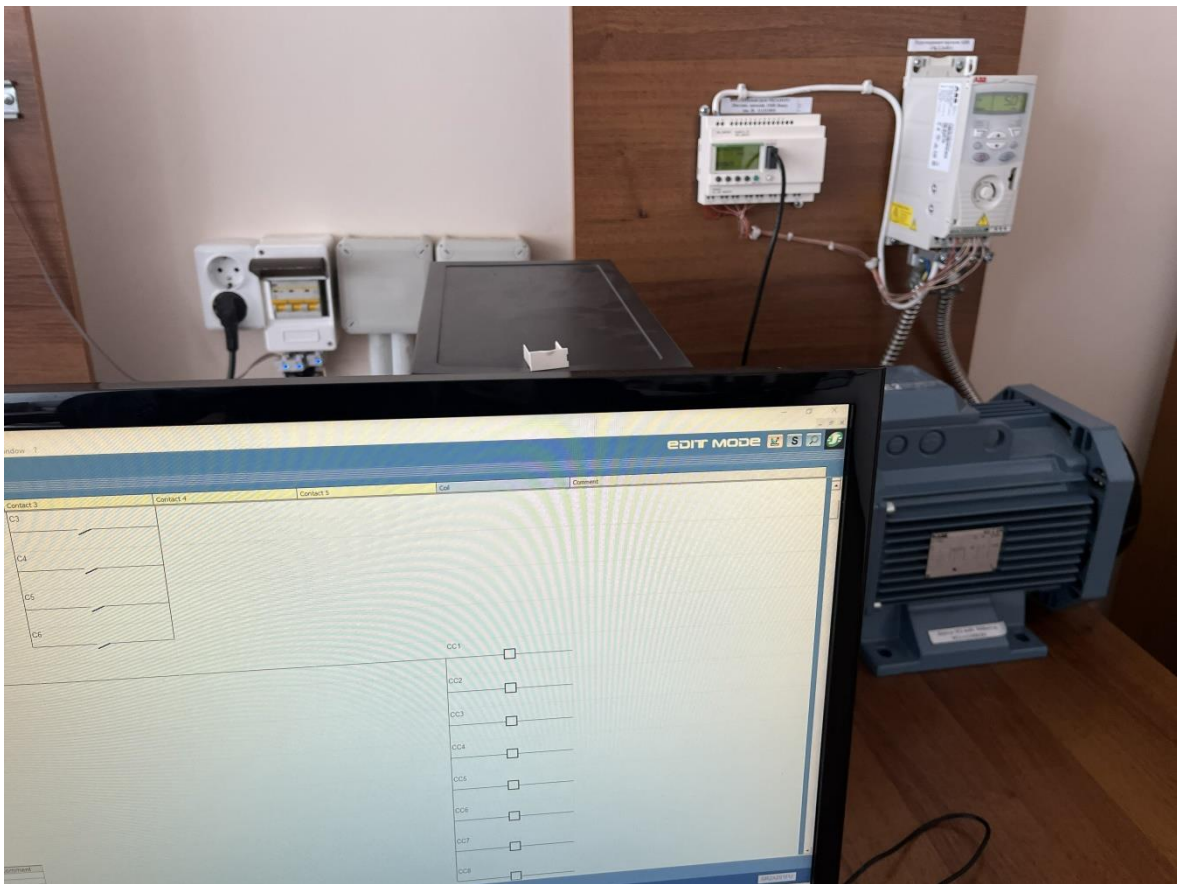
Рисунок 2.1 – Лабораторний стенд для вивчення програмованих логічних контролерів
