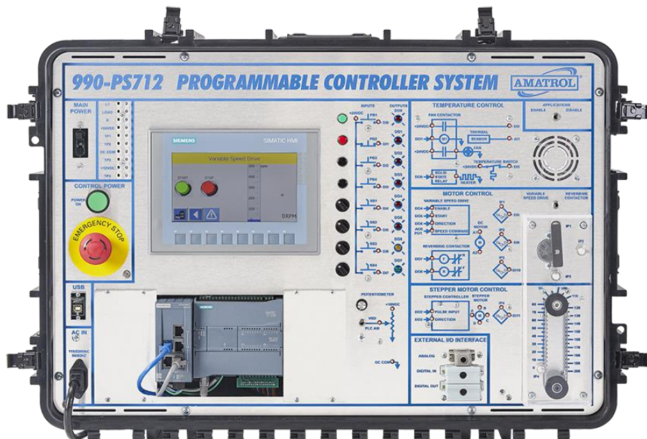
Рисунок 1.4 – Портативна система навчання з пошуку несправностей програмованих логічних контролерів Amatrol – Siemens S7-1200 (990-PS712F)
