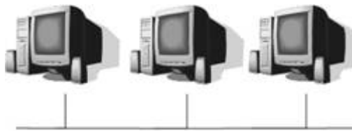
Рисунок 2.1 - Схема мережі з топологією "загальна шина"
