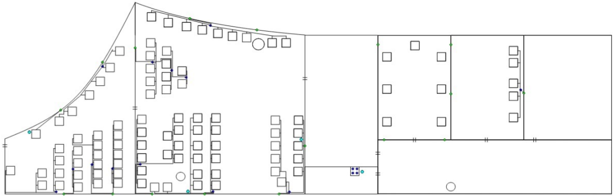
Рисунок 3.2 - Фізична схема побудови локальної мережі ТОВ «Smart Time»
