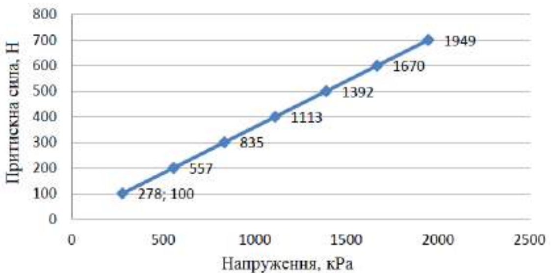
Рисунок 3.10 – Залежність притискної сили від напружень.
