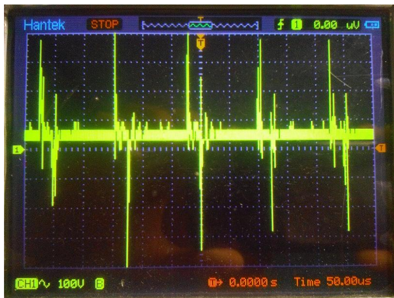
Рис. 4. Осцилограми розмаху викидів імпульсів регенованої енергії з двигуна на гальмівний резистор: а) t=5 мс, 100 В/кл.; б) t=50 мс, 100 В/кл.
