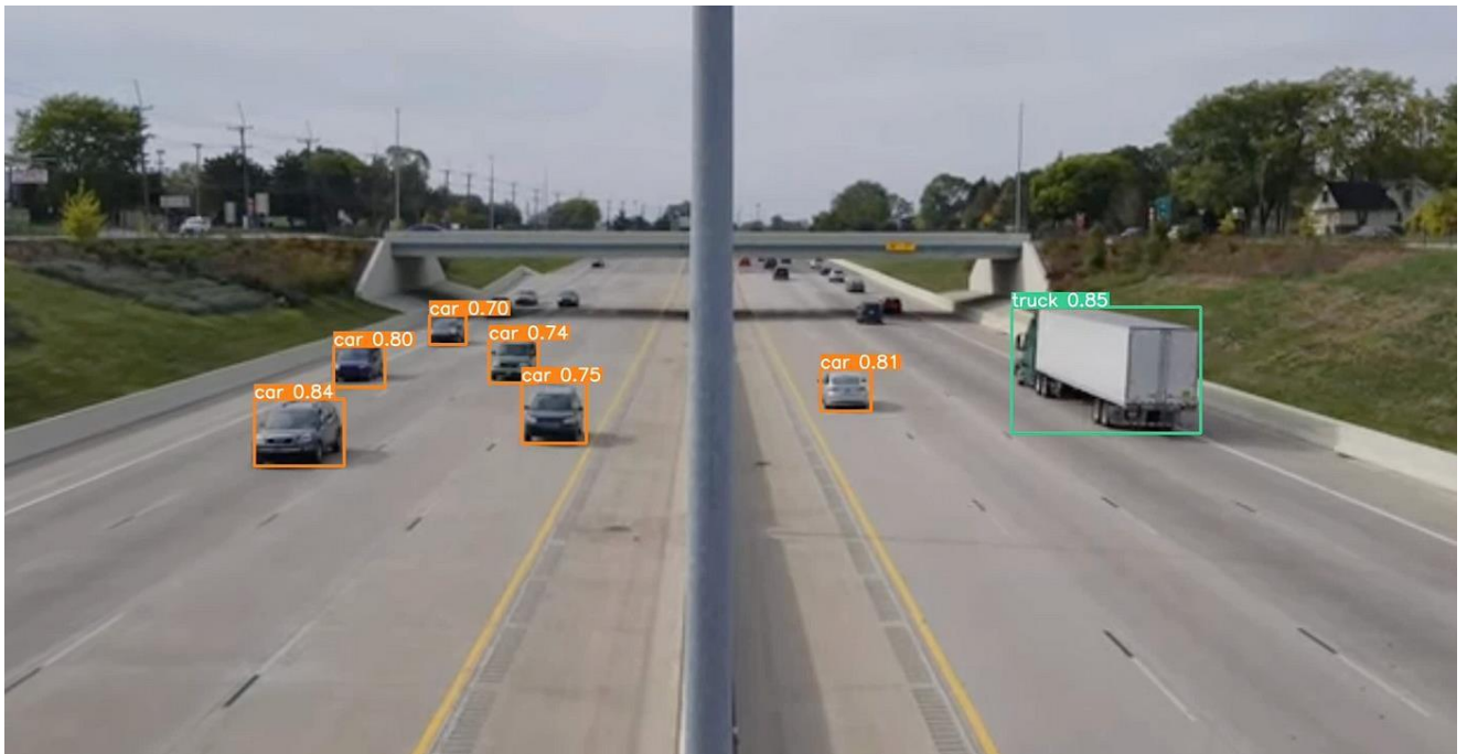
Рисунок 2.2 – Результат після обробки зображення за допомогою YOLOv5 [47]
