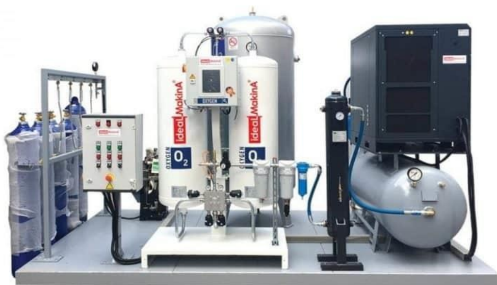
Рисунок В.3 - Обладнання запропонованої до впровадження кисневої станції
