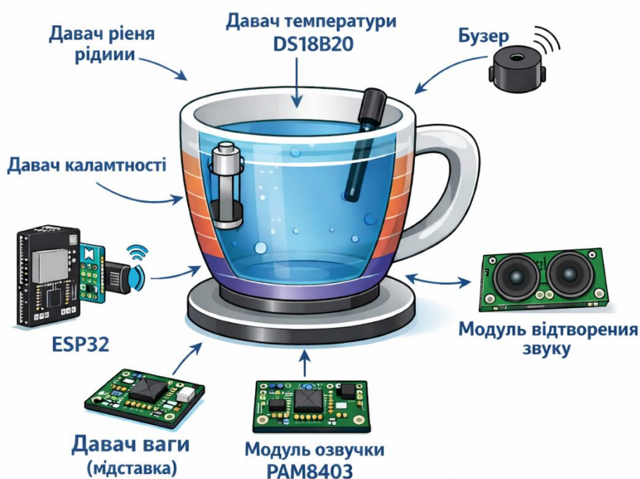
Рисунок 3.2 – Концептуальна схема КФС «Розумна чашка»
