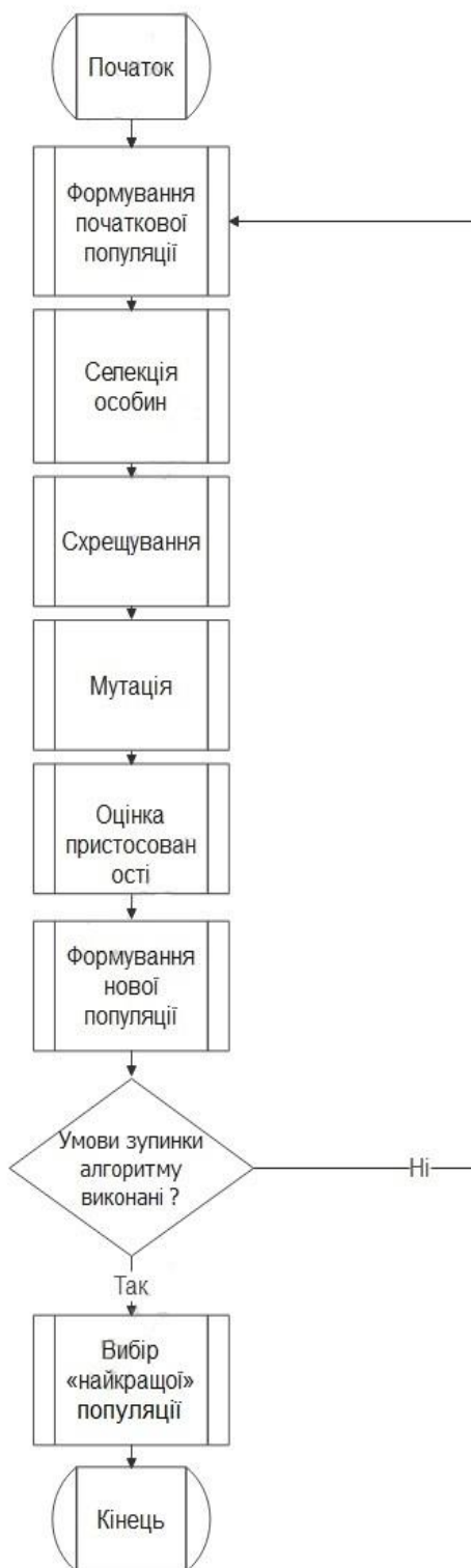
Рисунок 2.8 – Схема роботи генетичного алгоритму
