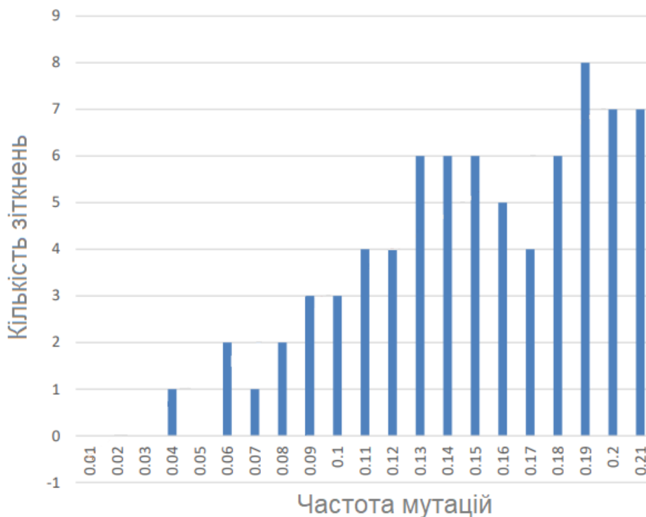
Рисунок 3.7 – Залежність кількості зіткнень від частоти мутацій
