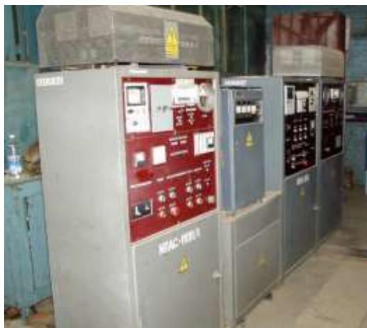
Рисунок 10 Загальний вид установки азотування в тліючому розряді УАТР-50 (варіант двокамерної установки)
