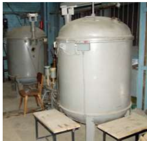
Рисунок 10 Загальний вид установки азотування в тліючому розряді УАТР-50 (варіант двокамерної установки)
