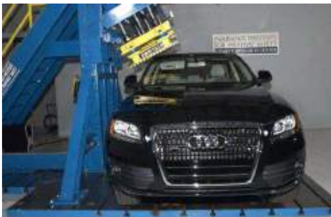
Рисунок 4.5 – Стенд перевірки міцності даху
