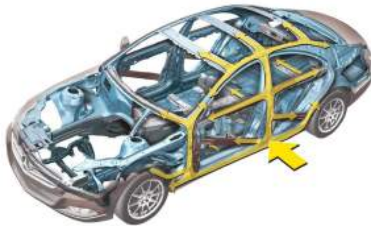
Рисунок 4.2 - Спосіб розподілу енергії удару при бічному зіткненні.
