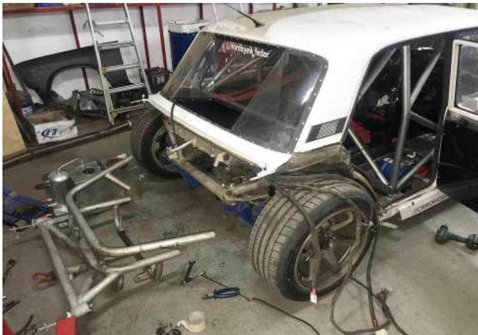
Рисунок 2.6 – Установка каркаса безпеки на ВАЗ-2105.
