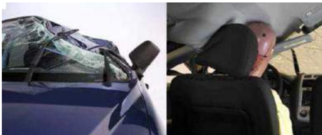
Рисунок 4.4 – Слабкі стійки даху та пошкодження голови водія:
