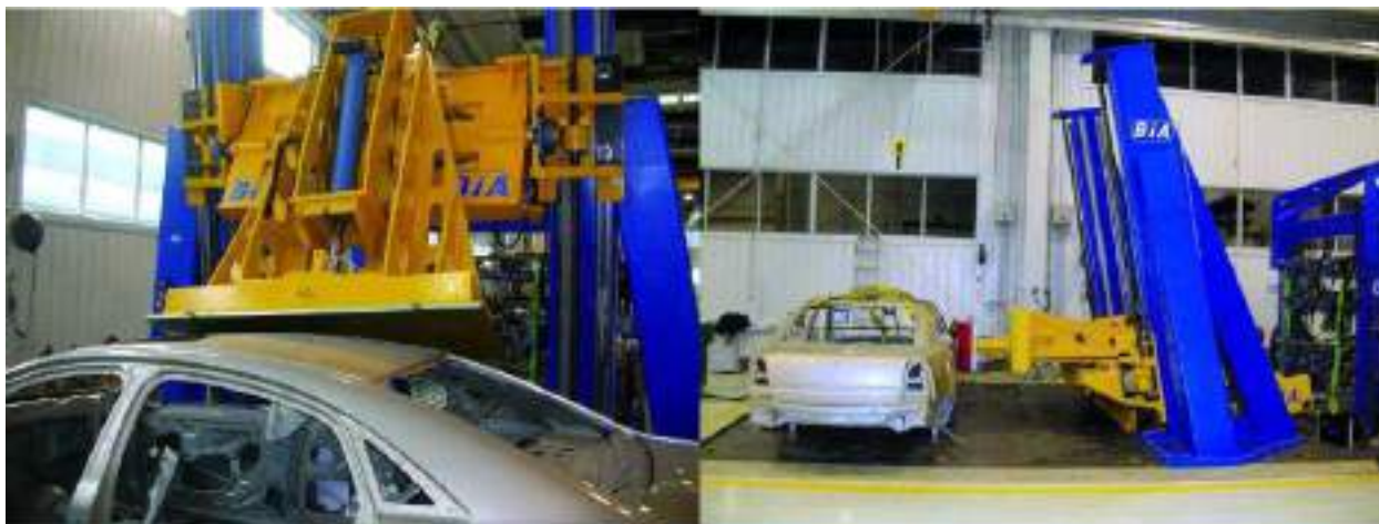
На рисунку 4.6 представлений процес випробування міцності даху та дверей автомобіля.
