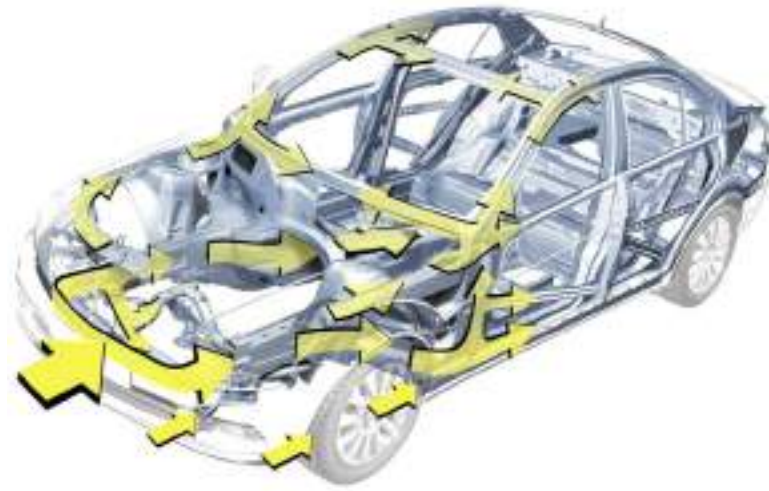
Рисунок 4.1 – Спосіб розподілу енергії удару при прямому зіткненні.
