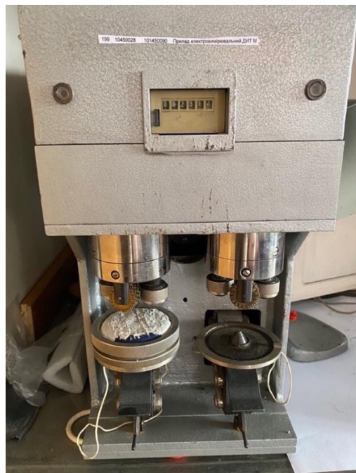
Рисунок 16- Прилад електровимірювальний ДИТ М (для визначення зносостійкості)
