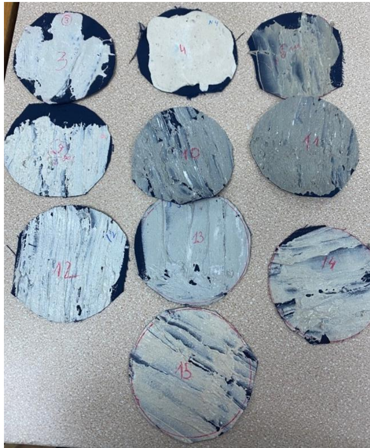
Рисунок 15– Підготовлені зразки ПК для визначення зносостійкості
