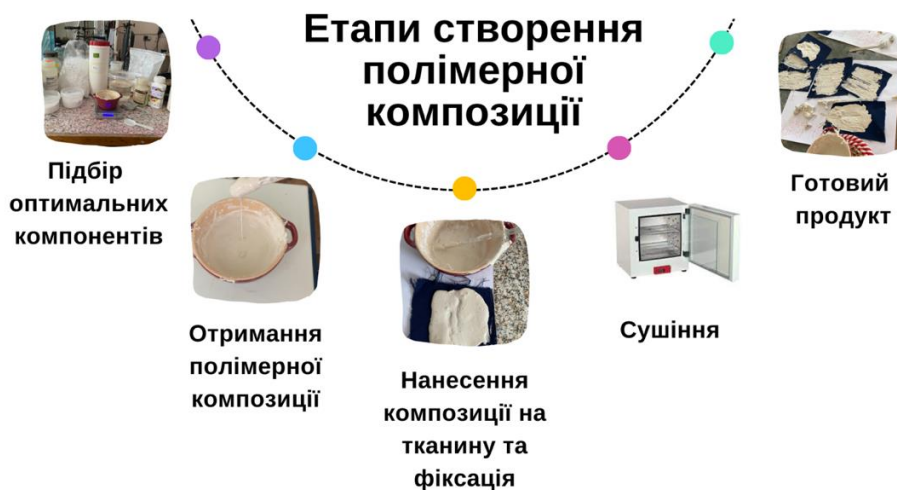
Рисунок 13– Етапи створення полімерної композиції
