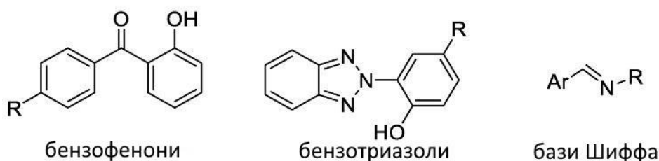
Рисунок 11 - Структури деяких поширених поглиначів ультрафіолетового випромінювання
