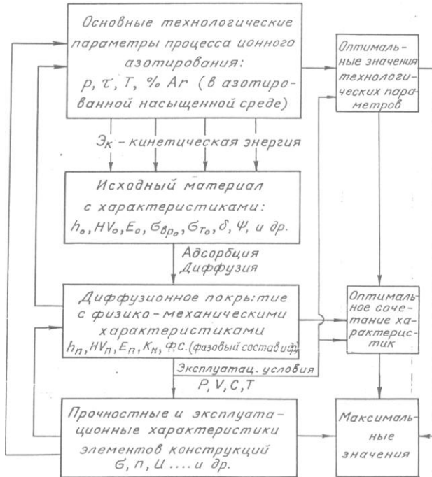
Рис. 5.1. Схема процесса формирования, эксплуатации и управления диффузионными покрытиями, полученными методом ионного азотирования
