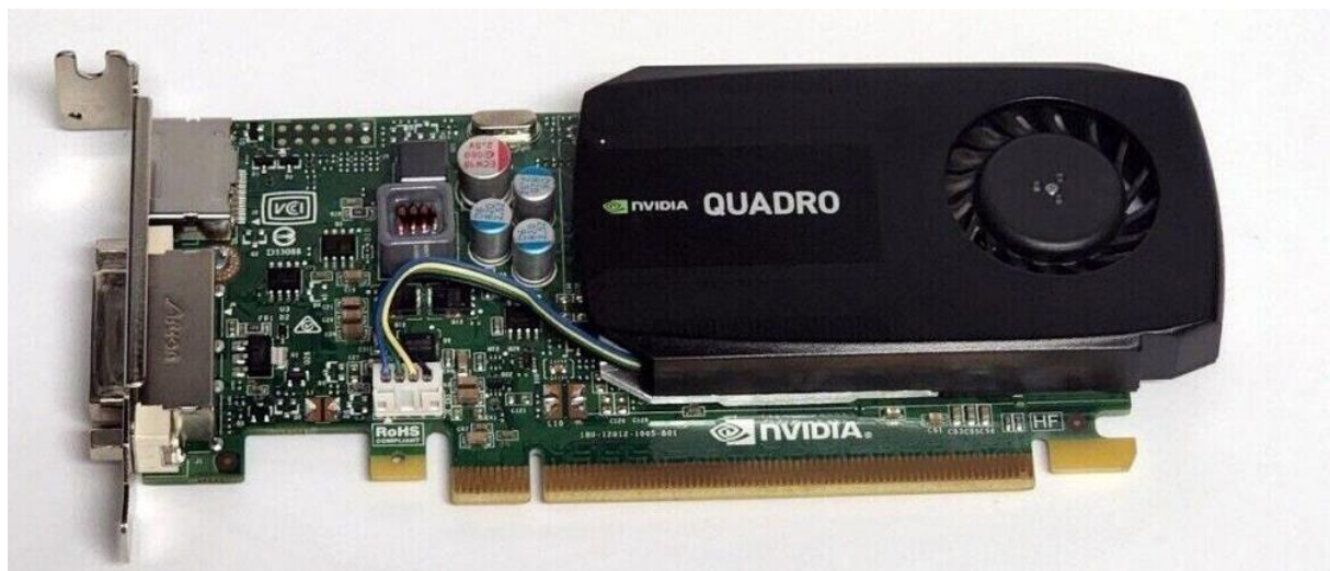
Рисунок 2.2 – Зовнішній вигляд дискретної відеокарти nVidia Quadro K420, 2 GB GDDR3, 128-bit / DVI, DisplayPort
