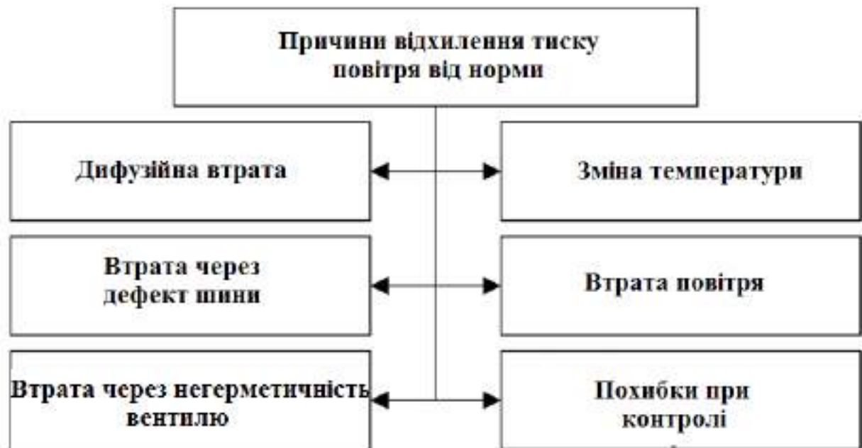
Рисунок 1.4 – Основні причини відхилення тиску повітря в шинах під час експлуатації автомобіля
