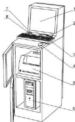
Рисунок 3.5 – Вид на стійку керування з відкритими дверцятами. Вигляд спереду: 1 – екран монітора, 2 – кнопка аварійної зупинки, 3 –
