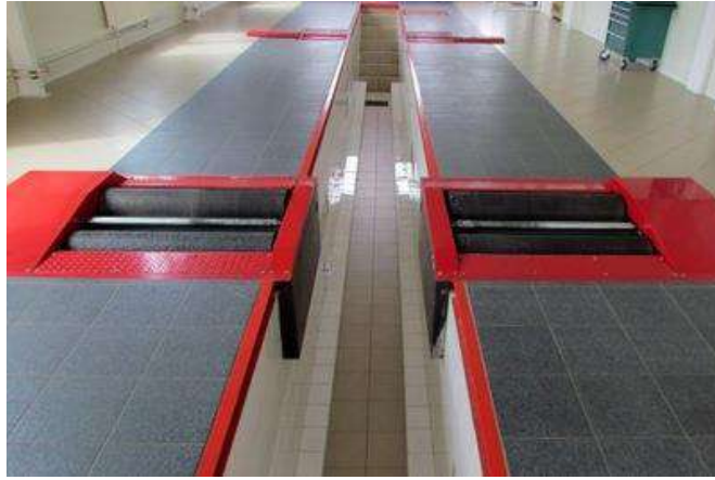
Рисунок 3.2 – Автомобільний роликівий гальмівний стенд Hoffmann
