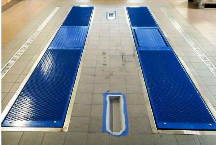
Рисунок 3.1 – Платформенний стенд для випробування гальм легкових автомобілів Neка Univers A4.
