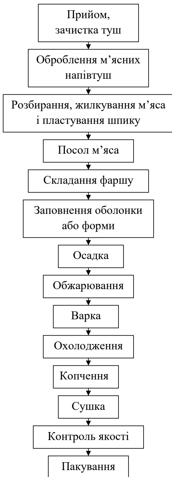
Рис. 2.1. Технологічна схема виробництва напівкопчених ковбасних виробів
