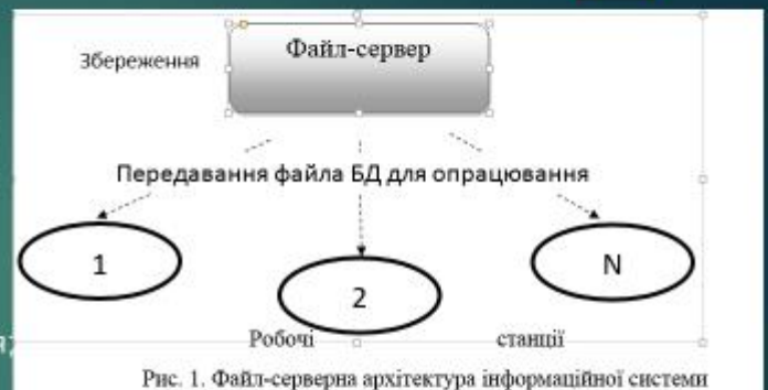
Рис. 1. Файл-серверна архітектура інформаційної системи
