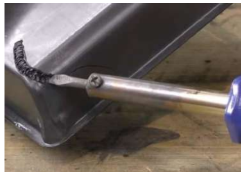
Рисунок 1.7 – Схема зварювання нагрітим інструментом (а) та відновлена деталь (б): 1 - деталі, що з'єднуються; 2 – інструмент; 3 – шов
