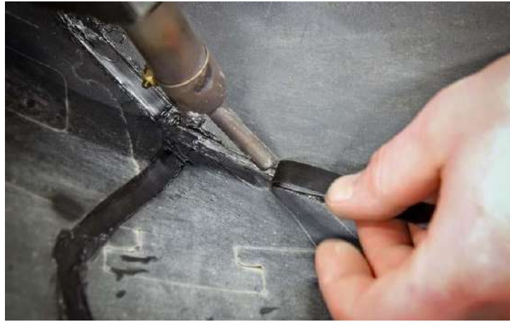
Рисунок 1.5 – Відновлення деталі зварюванням нагрітим газом
