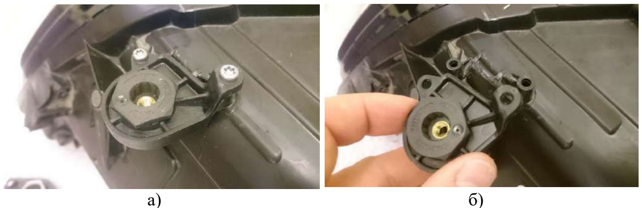
Рисунок 1.12 – Відновлення кронштейна фари (а) ремонтним комплектом (б)
