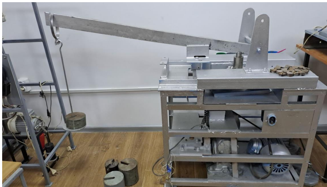
Рисунок 2.8 – Загальний вигляд експериментальної установки для дослідження процесу подрібнення полімерів
