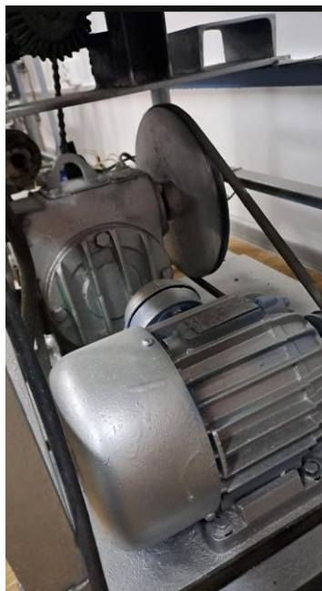
Рисунок 2.3 – Вузол приводу установки
