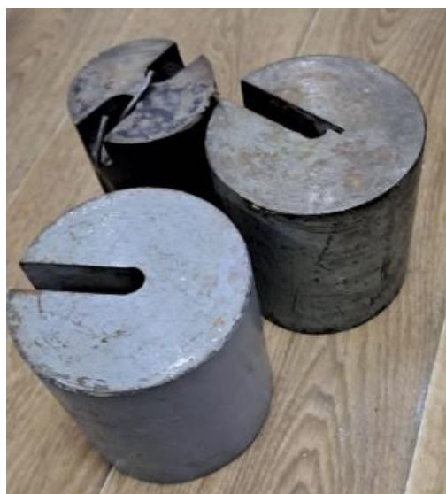
Рисунок 2.7 – Комплект змінних вантажів для створення навантаження
