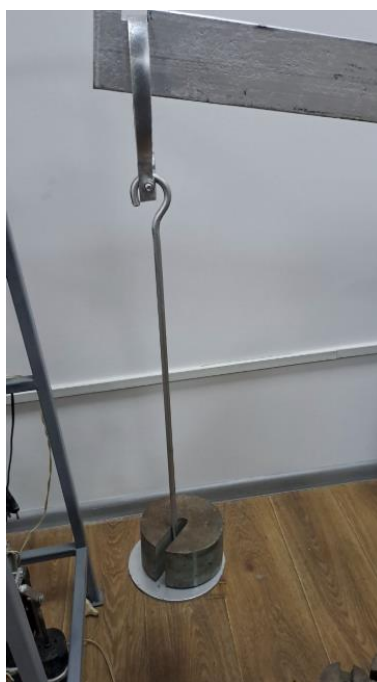
Рисунок 2.5 – Важільна система навантаження
