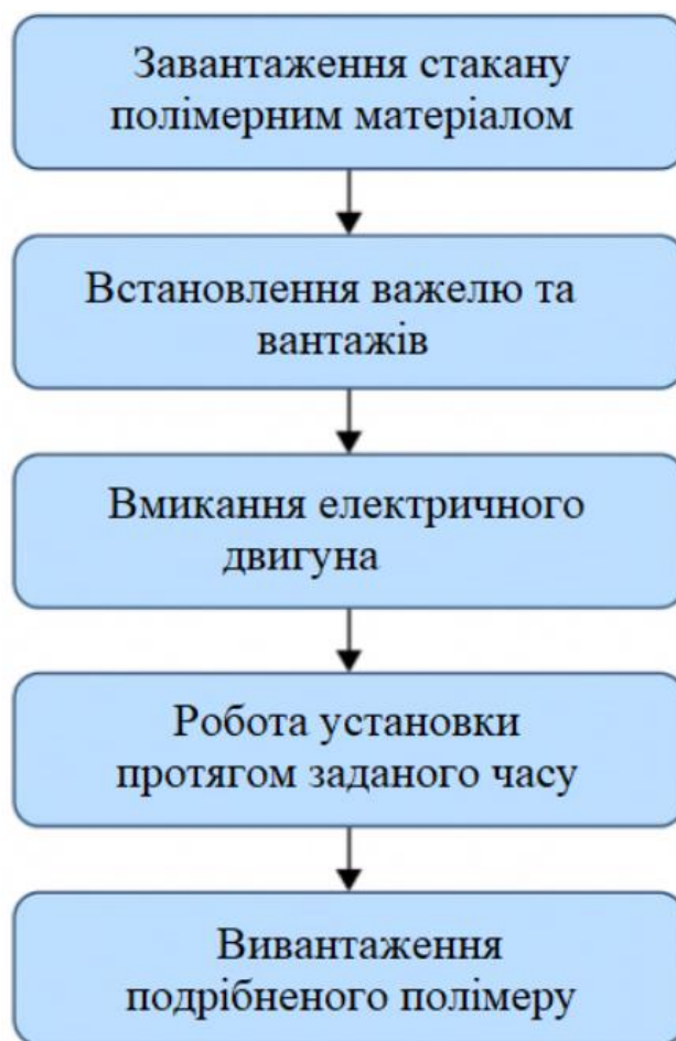
Рисунок 2.1 – Технологічний процес подрібнення полімерних матеріалів на установці, що розробляється
