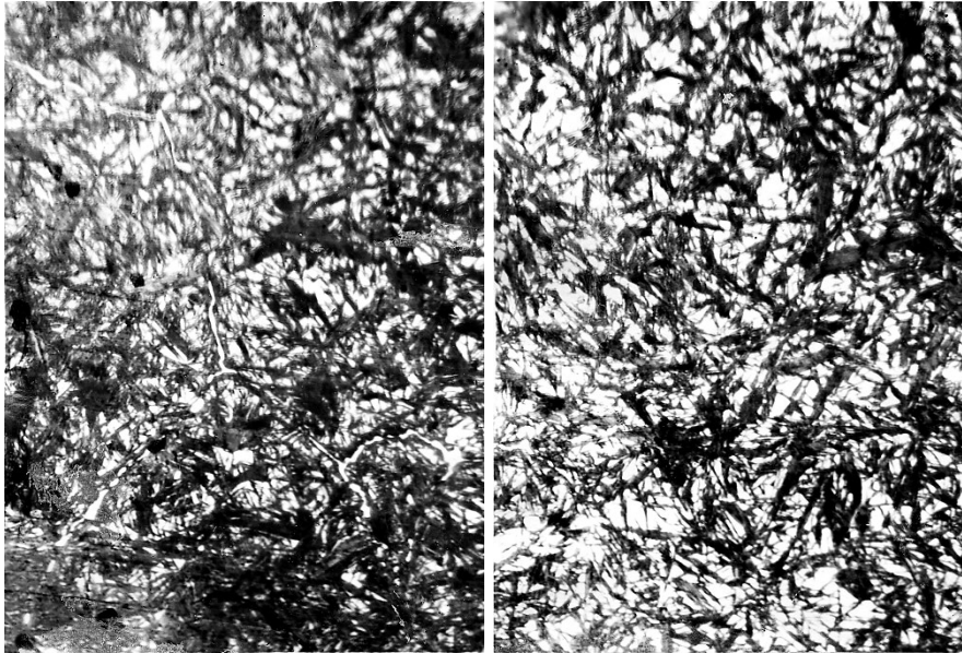
Рис. 4. Структура криці 12ХН3А після цементації та гартування: грубоголчастий мартенсит і залишки цементитної сітки на поверхні; \times 200 . Рис. 5. Мікроструктура криці 12ХН3А після цементації та гартування: загоголчастий мартенсит і залишковий аустеніт по глибині шару; \times 200 .
