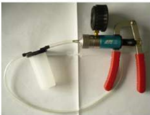
Рисунок 2.7 – Пристрій для відбору проб охолоджуючої рідини
