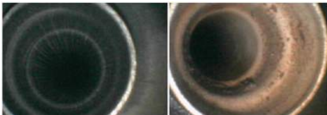
Рисунок 4.5 – Зовнішній вигляд поверхні трубок для нового радіатора (зліва) і радіатора, після заміни антифризу автомобіля ЗАЗ-FORZA.
