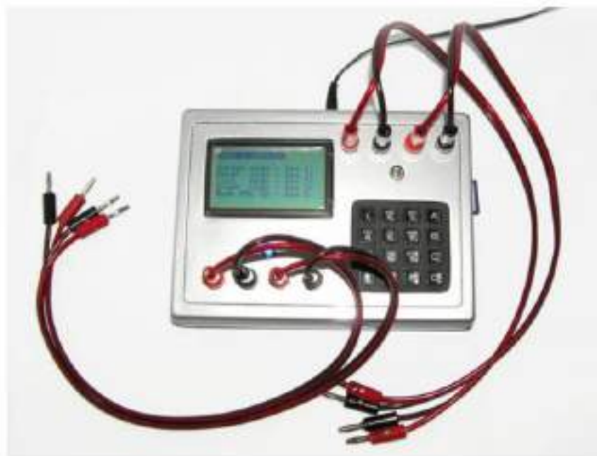
Рисунок 2.4 – Зовнішній вигляд приладу для визначення електропровідності антифризів
