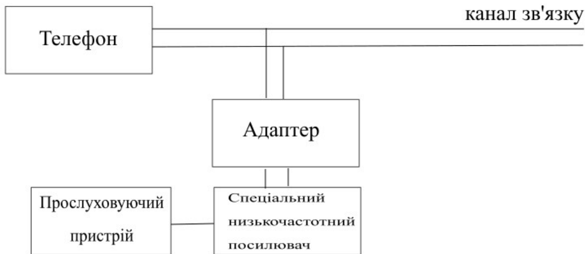
Рисунок 1.1 Схема підключення спеціальних посилювачів до телефонної лінії через адаптер
