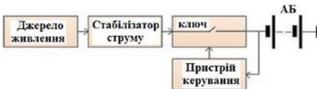
Рисунок 2.7 – Схема заряду батареї струмом стабілізованим.
