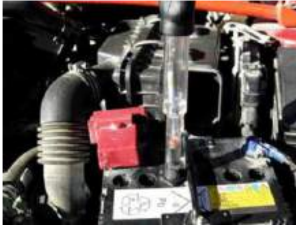
Рисунок 3.17 – Вимірювання щільності електроліту ареометром.
