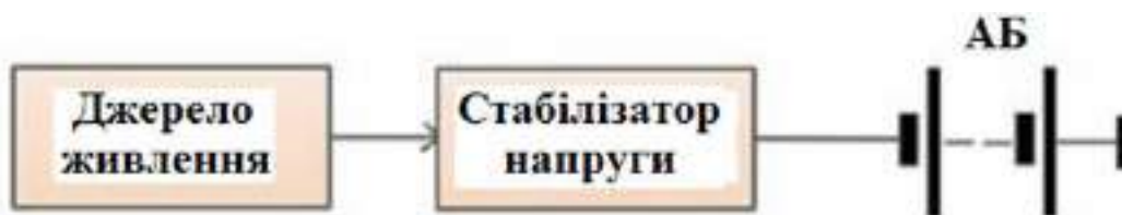
Рисунок 2.8 – Схема заряду батареї напругою стабілізованою.
