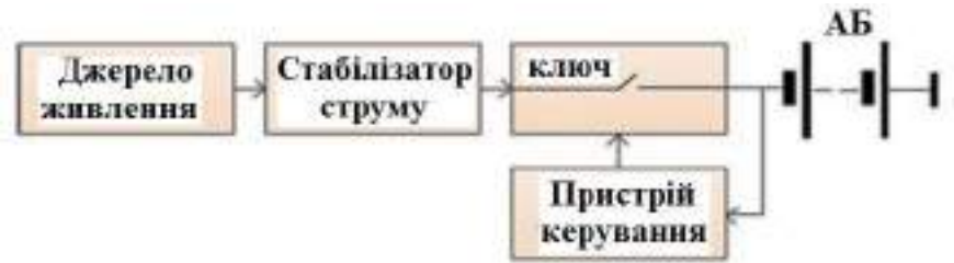
Схема відновлення заряду АКБ стабілізованим струмом
