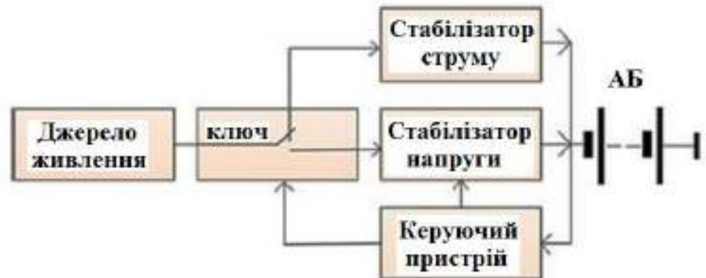
Схема відновлення заряду АКБ на двоступінчатому відновленні зарядному пристрої
