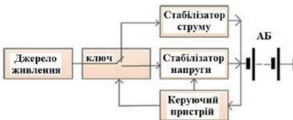
Рисунок 2.9 – Структурна схема двоступінчастого зарядного пристрою
