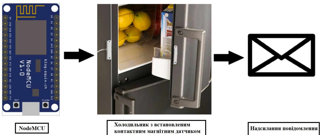
Рисунок 3.13 – Схематичне зображення принципу роботи пристрою
