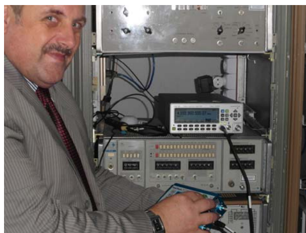
Рис.28 . Практичні вимірювання частоти із розділення менше 1мГц
