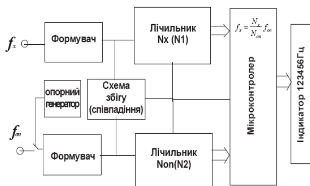
Рис.19. Структурна схема частотоміра реперних точок
