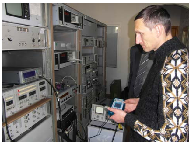
Рис.28 . Практичні вимірювання частоти із розділення менше 1мГц
