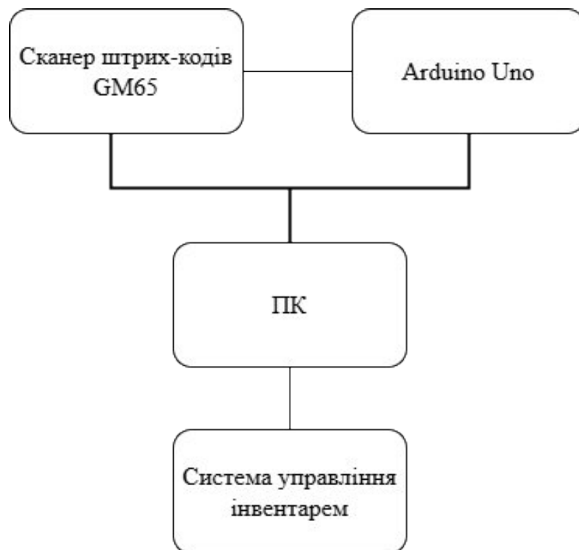
Рисунок 2.1 – Загальна схема апаратної архітектури системи [59]
