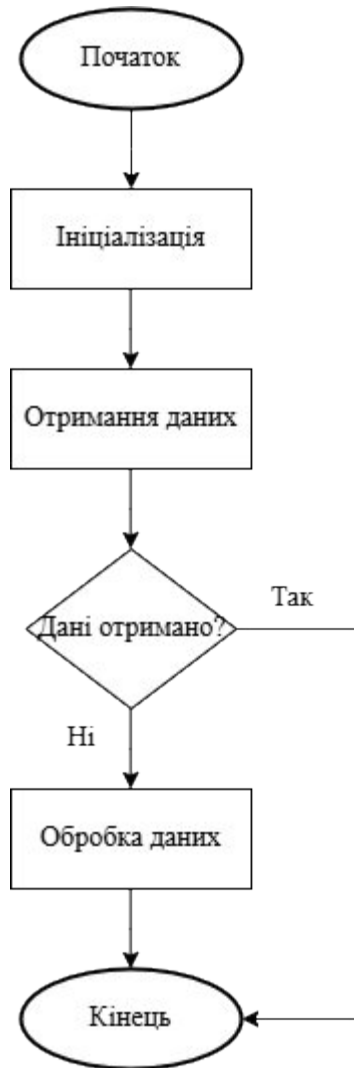
Рисунок 2.4 – Блок-схема алгоритму обробки даних Arduino [62]
