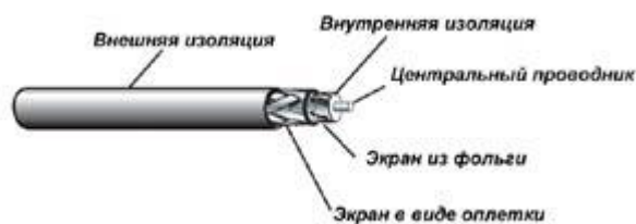
Малюнок 1.4 – Структура коаксіального кабелю
