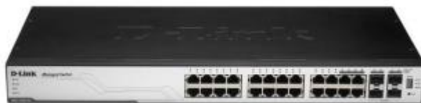
Рисунок 2.2 – Комутатор D-link DGS-3100-24
