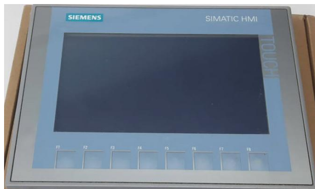
Рисунок 2.3 – Панель оператора Simatic HMI KTP700 Basic номер за артикулом 6AV2123-2GB03-0AX0
