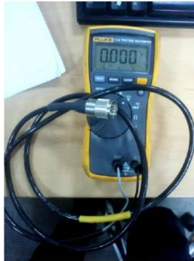
Рисунок 2.12 – Вимірювальний прилад із спеціальною насадкою для приймання передавача обладнання Ericsson Mini-Link
