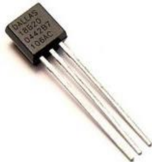
Рисунок 1.1 Цифровий датчик температури DS18B20
